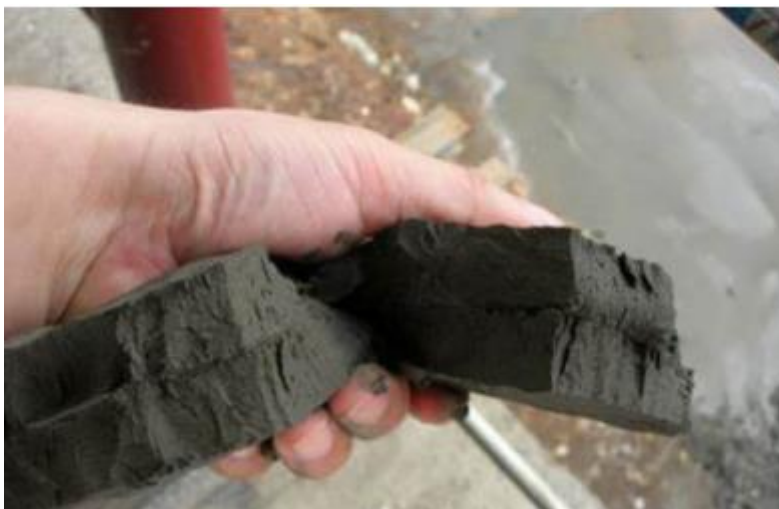
Slika 3. Slika koja prikazuje konzistenciju filtrirane jalovine na VPP-u
